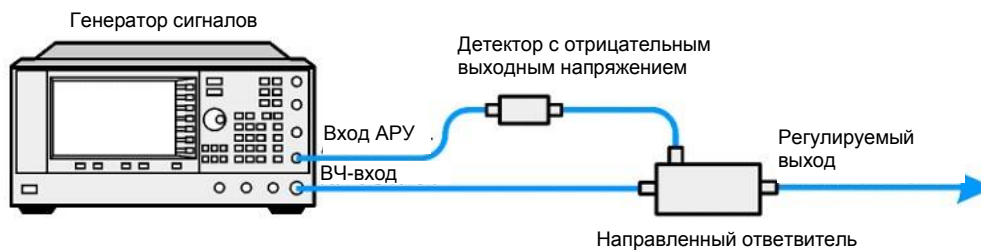
Рисунок 4-2. Внешняя регулировка мощности с детектором и направленным ответвителем
